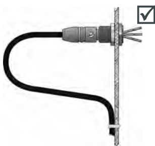
Entlastungsschleife – richtig Correct stress loop
