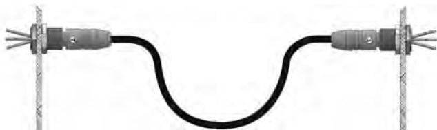
Kabelschleife Cable loop
